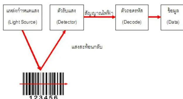
ภาพที่ 6 หลักการทำงานของเครื่องอ่านบาร์โค้ด
